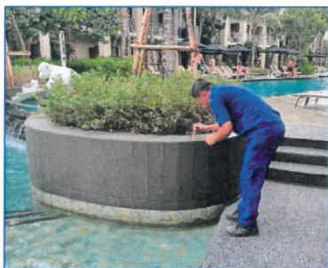
ภาพถ่ายที่ 3.4.11-1 การตรวจเช็คความเป็นกรดด่าง และคลอรีนอิสระคงเหลือทุกวัน
